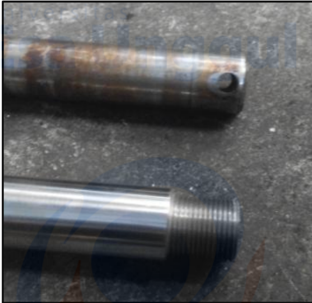
Gambar 4.25 Piston rod dengan sistem ulir
