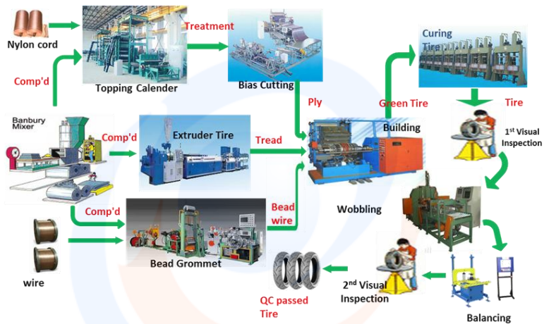
Gambar 4.1 Gambaran Umum Proses Produksi Ban Motor
